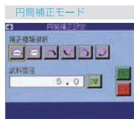
球面・円筒の試験時の補正を設定
